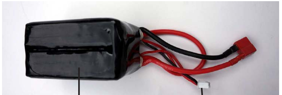
Batterie lipo nacelle 7.4V 4500mAh
